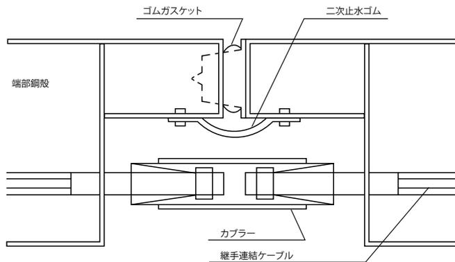
図-5.5 継手構造概念図
